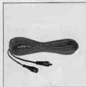
Lautsprecherkabel 375a mit 5 m Länge, 376a mit 10 m Länge. Hochflexible, geschmeidige Feinkupferlitze, 2 x 1 mm 2 , mit hervorragendem Leitwert. Ausgerüstet mit Steckvor- richtungen nach DIN 41529.
